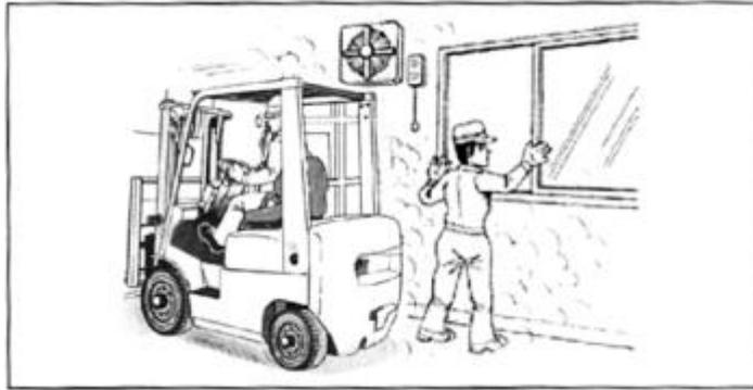
Dans un entrepôt fermé, les gaz d'échappement émis par le fonctionnement du moteur peuvent provoquer des risques toxiques et des décès dans les pires conditions. Ouvrez les fenêtres et les portes pendant la production et allumez le ventilateur pour assurer la ventilation. En cas d'opération prolongée dans l'entrepôt, il est nécessaire de rechercher en détail la capacité de ventilation.
