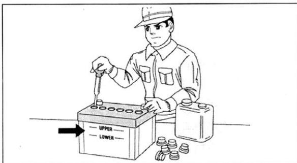
Si la batterie est changée lorsque le niveau de l'électrolyte est en dessous du NIVEAU INFÉRIEUR, cela peut endommager la batterie, réduire sa durée de vie et même provoquer une explosion.
