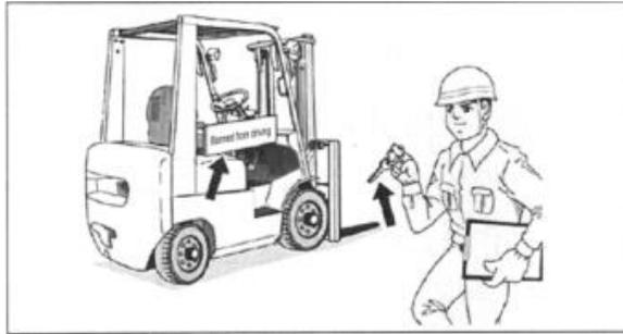
La clé d'un chariot élévateur défectueux doit être retirée et un panneau indiquant "AUCUNE UTILISATION" doit être apposé.
