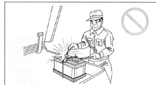
Ne laissez aucun métal entrer en contact direct avec les bornes de la batterie – et + pour éviter les courts-circuits. Une borne – mal serrée peut provoquer des étincelles en raison d'une connexion défectueuse, ce qui peut entraîner une explosion. Les bornes doivent être correctement serrées. Après avoir retiré la batterie, vérifiez ses bornes – et +. Ne les reconnectez pas à l'envers lors de la réinstallation de la batterie..
