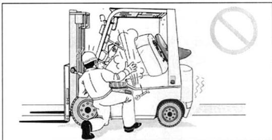
L'huile du moteur peut être à haute température et sous haute pression après le fonctionnement du chariot élévateur. La vidange d'huile et le remplacement du filtre dans ces conditions peuvent entraîner le projet d'huile chaude, ce qui peut facilement provoquer des brûlures.
