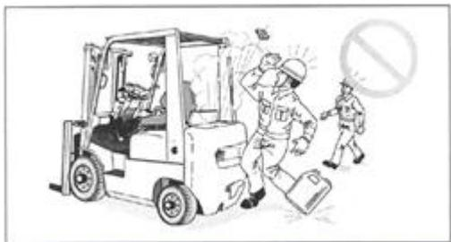
Le liquide de refroidissement est à haute température et pression après l'utilisation du chariot élévateur. Ne pas ouvrir le couvercle du réservoir d'eau dans ces conditions ; sinon, le liquide de refroidissement à haute température pourrait éclabousser et provoquer des brûlures.
