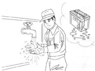
L'électrolyte de la batterie contient de l'acide sulfurique dilué, qui corrode les vêtements et la peau. En cas de contact avec les vêtements ou la peau, rincez immédiatement à grande eau.
