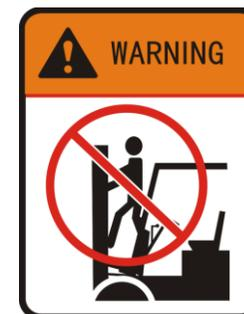
Il est dangereux d'utiliser la carrosserie du chariot élévateur comme échelle et le mât comme échelle. Une opération involontaire du levier de commande peut provoquer un mouvement imprévisible du mât, et la personne peut être écrasée entre le mât et la carrosserie, entraînant des accidents graves.
