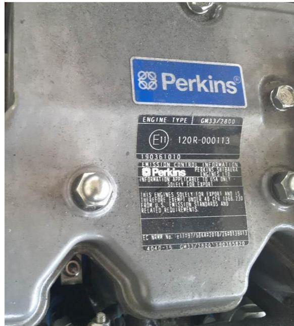
Le numéro de moteur est marqué sur le bloc droit sous le collecteur d'échappement et sur une étiquette située sur la partie supérieure du cache-culbuteurs.
