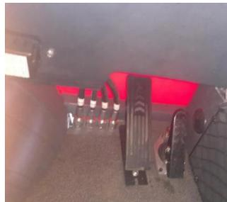
Appuyez sur la pédale (1) pour arrêter progressivement la machine. Vous pouvez accélérer le moteur pour déplacer le bras horizontal plus rapidement. Appuyez sur la pédale jusqu'au plancher pour activer progressivement le frein de service. Relâchez lentement la pédale. La machine commencera à se déplacer.
