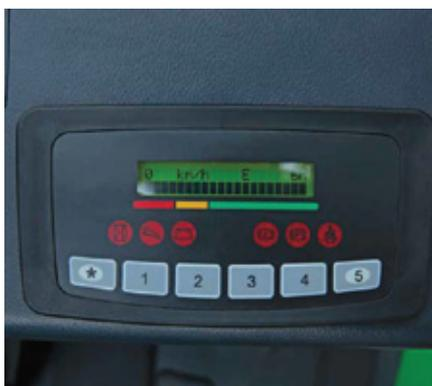
Contrôleur Zapi avec tableau de bord multifonctionnel
