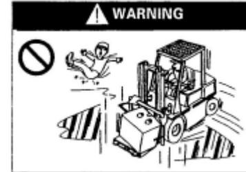
5. Ne tentez pas de soulever ou de déposer une charge à moins que le chariot élévateur soit à niveau !
