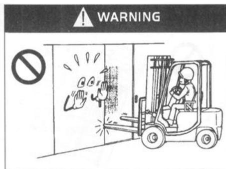
Ne pas utiliser le chariot élévateur de manière inappropriée !
