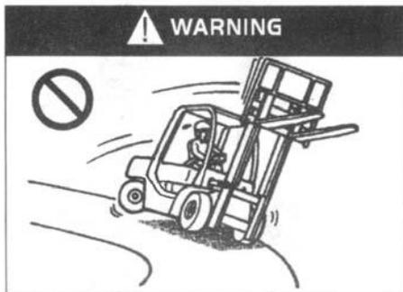
Lorsque les fourches sont levées sans charge, veuillez tourner avec un angle réduit
