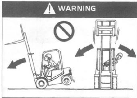
Lors du déplacement, la distance entre les fourches et le sol doit être inférieure à 150 mm à 200 mm !
