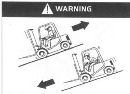
Lorsque le camion est à vide, reculez en montée et avancez en descente
