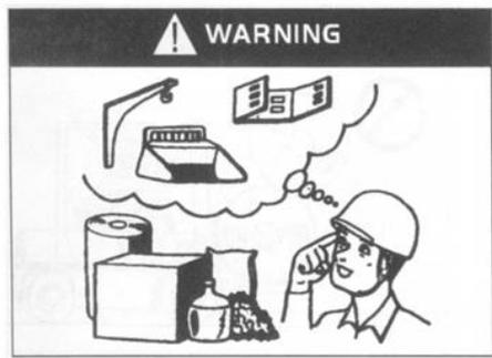
Vérifiez le changement du poids de charge nominal avant d'utiliser le chariot élévateur
