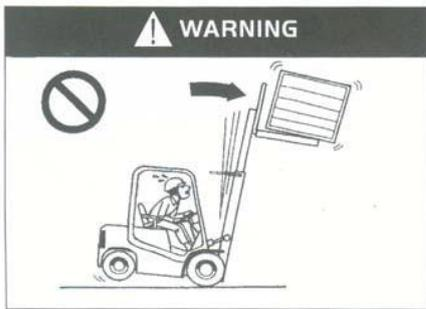
Interdiction d'incliner vers l'avant pour améliorer le chargement, afin d'éviter le basculement !
