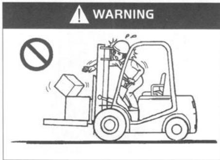
Ne dépassez aucune partie du corps à l'extérieur en conduisant !
