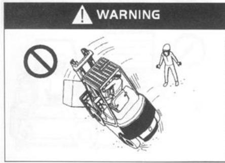
En tournant à grande vitesse, l'instabilité du centre de gravité peut provoquer des accidents
