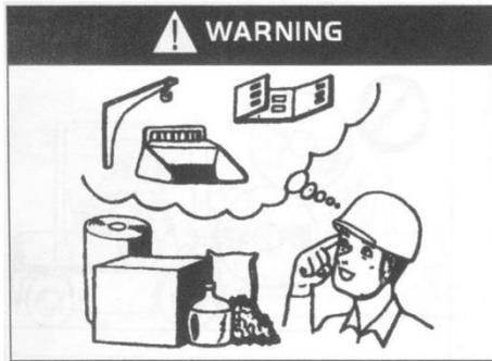
Evaluer le poids de la charge à transporter avant d'utiliser le chariot élévateur.
