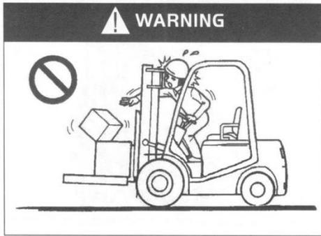
N'étendez aucune partie du corps à l'extérieur en conduisant!
