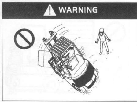
Tourner à grande vitesse, peut causer un accident à cause d'un centre de gravité instable !
