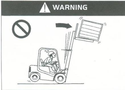
Ne pas incliner le mât vers l'avant avec chargement pour éviter un basculement !
