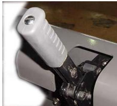
Utilisez ce levier de frein de stationnement pour garer le chariot élévateur. Et les freins de stationnement sont appliqués sur les deux roues avant deux roues avant en tirant sur ce levier. Pour relâcher les freins de stationnement, déplacez le levier vers l'avant.
